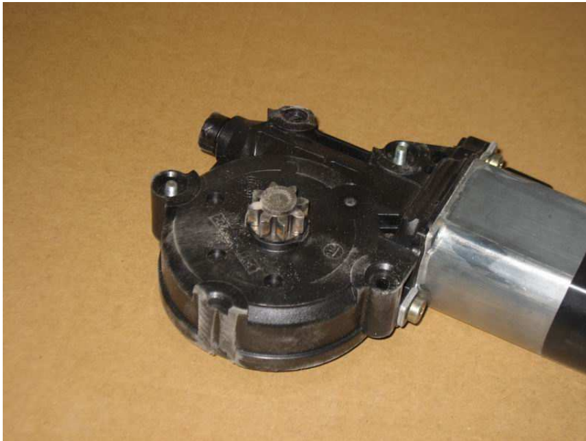
Motor mit gekürzter Achse.
