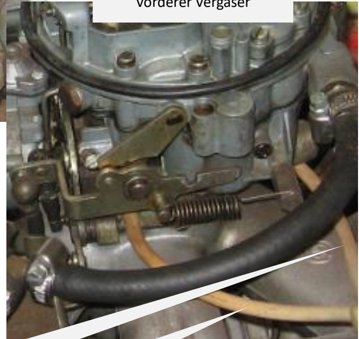
Unterdruckschläuche am vorderen Vergaser zu Zündverteiler
